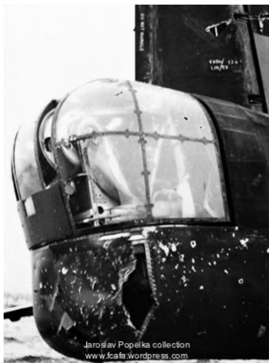
Obr. 14 - Zničená střelecká věž a poškozený trup Wellingtonu KX-G Z1147 po návratu z náletu na Emden. V zadní věži byl smrtelně zraněn F. Binder.
